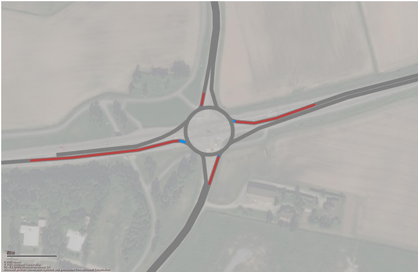
Kuva 18. Tampereentien (Vt 12) ja Kirkkotien/Suosmerentien välisen kiertoliittymän jonopituudet iltahuipputunnin aikana ennustetilanteessa. Punaisella maksimijonopituus, sinisellä keskimääräinen.
